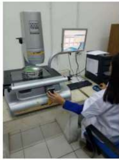
Gambar 3. Teknik pengujian non-kontak menggunakan CMM optik.
