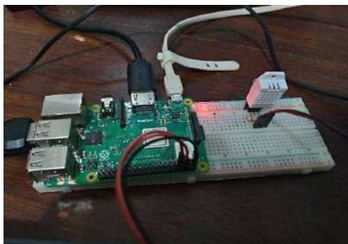
Gambar 3. Rangkaian pemasangan alat sensor DHT11 ke Raspberry pi untuk pengujian
