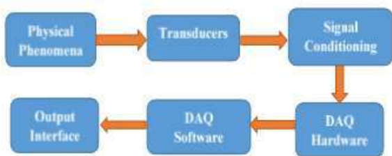
Gambar 1 Diagram blok sistem akuisisi data
