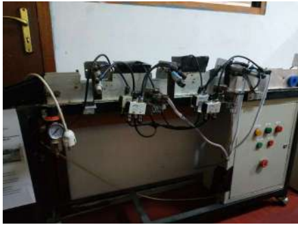
Gambar 3. Model mesin Pemilah Kualitas Telur Bebek Berbasis Image Processing
