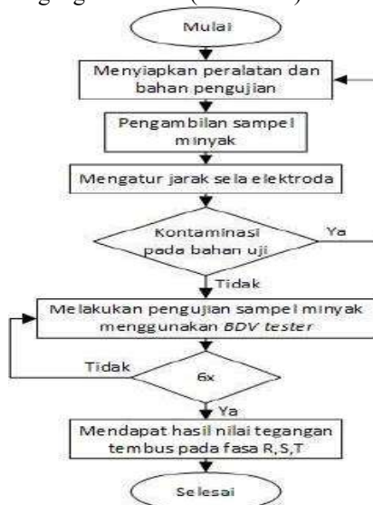
Gambar 2. Prosedur pengujian tegangan tembus (BDV)
