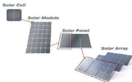
Gambar 1 Urutan Penyusunan Fotovoltaik [3]
