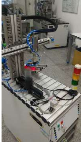
Gambar 2. Hasil pemasangan komponen pada plat alumunium
