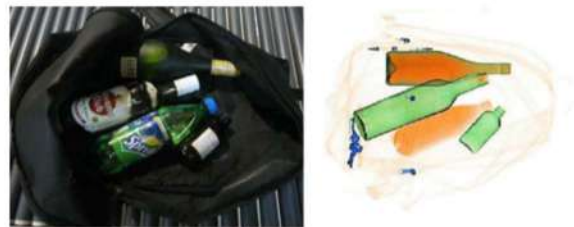
Gambar 1. Gambar hasil X-Ray dengan benda berdensity rendah. (Alex, 2011)
