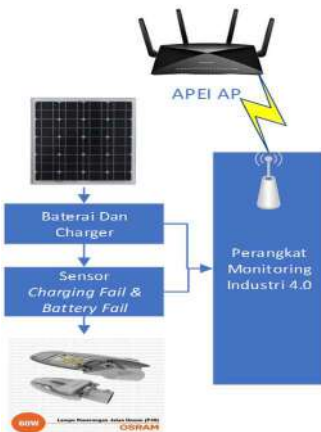
Gambar 1. Blok Diagram Kinerja PJU terhadap Charging Fail dan Battery Fail
